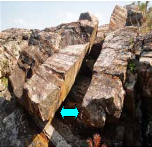
図 21 破断し、ズレ動いた岩盤の例
