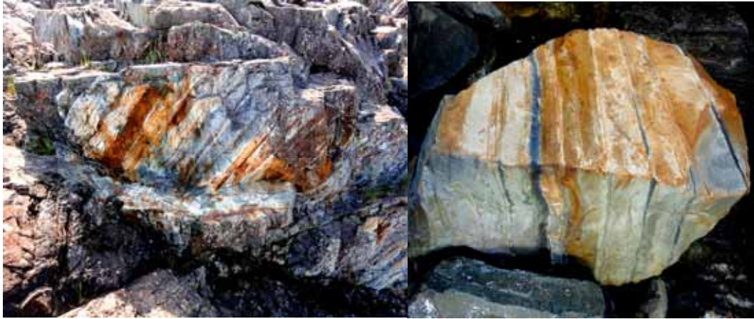
図 19 新鮮な破断面の破壊・崩落石の例
